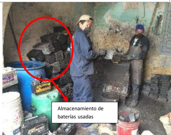
Foto No. 08 – Detalle armado de baterías e inadecuado almacenamiento de baterías – contaminación directa al suelo
