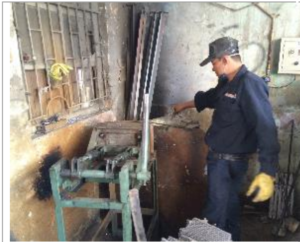
Foto No. 05 –Fundición láminas de Plomo llevado a cabo en el predio con nomenclatura urbana nomenclatura urbana KR 68 G No 73 A – 42/44
