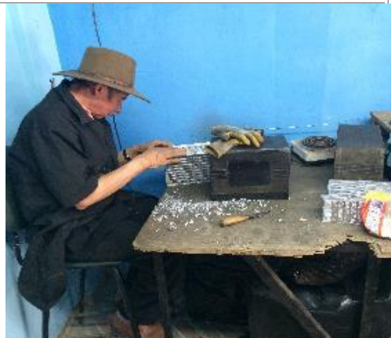
Foto No. 06 – Pulimento de láminas de plomo, llevado a cabo en la predio ubicado en la nomenclatura urbana KR 68 G No 73 A – 32
